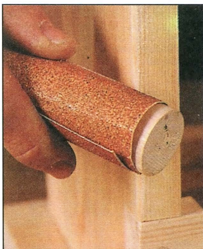
Инструмент для скругления ребер — крупная шлифовальная шкурка, обернутая вокруг бруска Ø25 мм.
