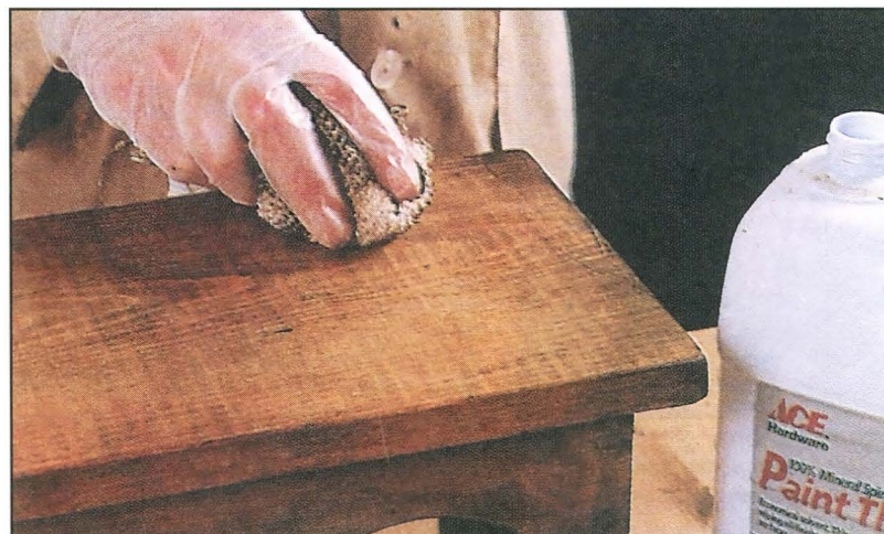
До высыхания грунта все места с «небольшим износом» протирают растворителем.
