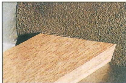
Если кромку доводят на дисковом шлифовальном станке, чтобы не снять лишнего, проводят четкую линию стыка.
